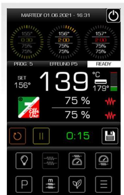
Falls das geladene Programm mehr als eine Stufe hat, werden diese Stufen im oberen Bereich des Displays durch kreisförmige Kronen dargestellt, deren Balken im Laufe der Zeit farbig werden.
