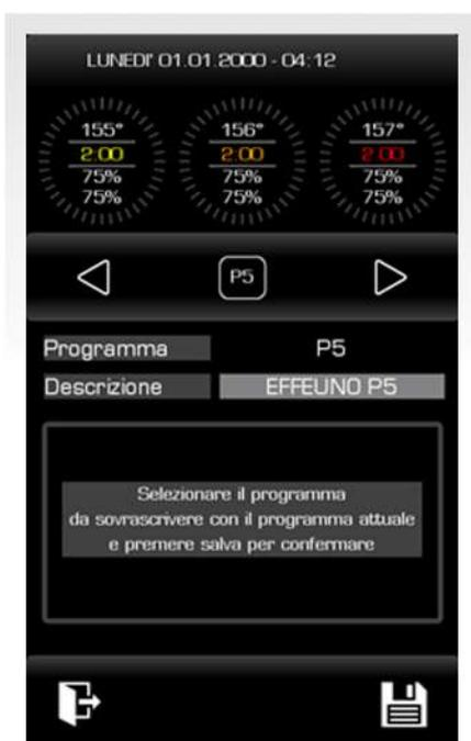
Von dieser Seite aus kann das aktuelle Programm in einem der verfügbaren Programme (von 1 bis 30) gespeichert werden.
