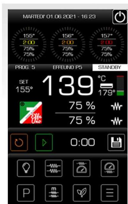
Von der Hauptseite aus ist es möglich, den aktuellen Status der verschiedenen Ofenkomponenten abzurufen und die vom Benutzer am häufigsten verwendeten Bedienelemente und Einstellungen zu bedienen.
