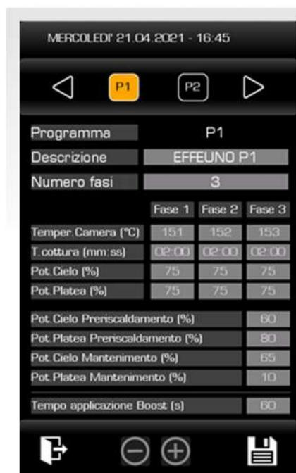
Für jedes der 30 Programme ist es möglich, den Namen zu ändern (über ein alphanumerisches Tastenfeld, das auf dem Bildschirm erscheint), die Anzahl der Stufen und, als Parameter, den Sollwert für die Obere-/Untertemperatur, die Backzeit, die Obere-/Untertemperatur-Prozentanteile und die Prozentanteile, die im Vorheiz- und Haltemodus anzuwenden sind.
