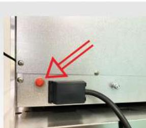
Nachdem die Sicherung ausgelöst wurde, gehen Sie wie folgt vor, um den Ofen regulär neu zu starten: trennen Sie die Stromversorgung, schrauben Sie die rote Kappe ab und drücken Sie den Taster des Sicherheitsthermostats auf der Rückseite des Backofens, bis er vollständig zurückgestellt ist.
